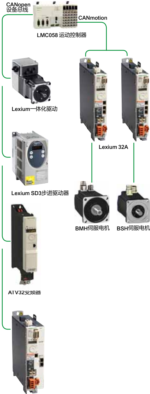
Lexium 32M伺服驱动器 采用CANopen和CANmotion设备总线的控制系统架构示例
